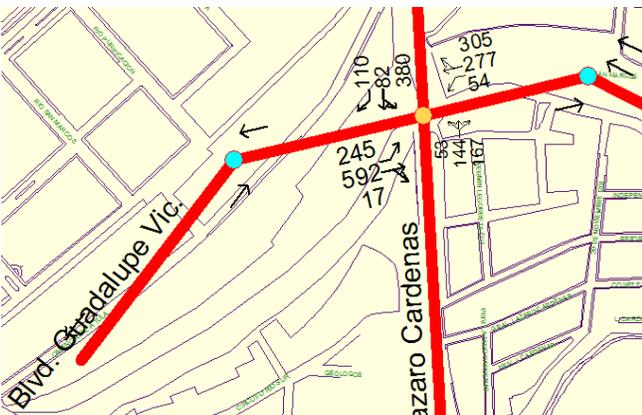
Figura 14. Intersección 12 volumen y movimientos actuales de primera hora pico.
