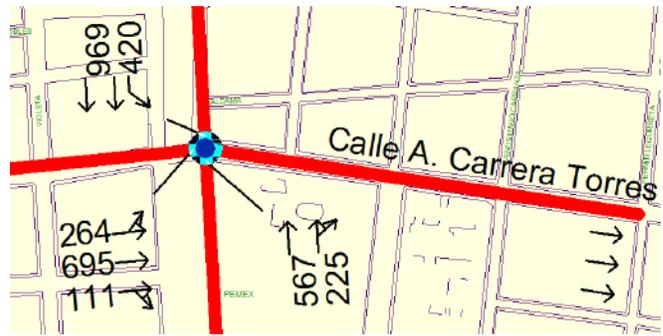
Figura 34. Volumen y movimientos con adecuación intersección 8.
