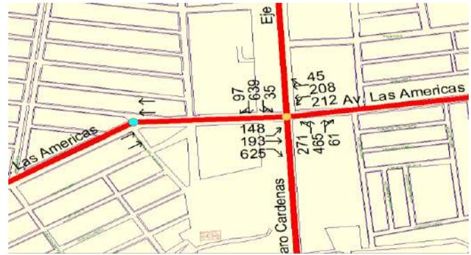
Figura 4. Intersección 2 volumen y movimientos actuales de primera hora pico.
