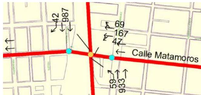
Figura 35. Volumen y movimientos con adecuación intersección 9.
