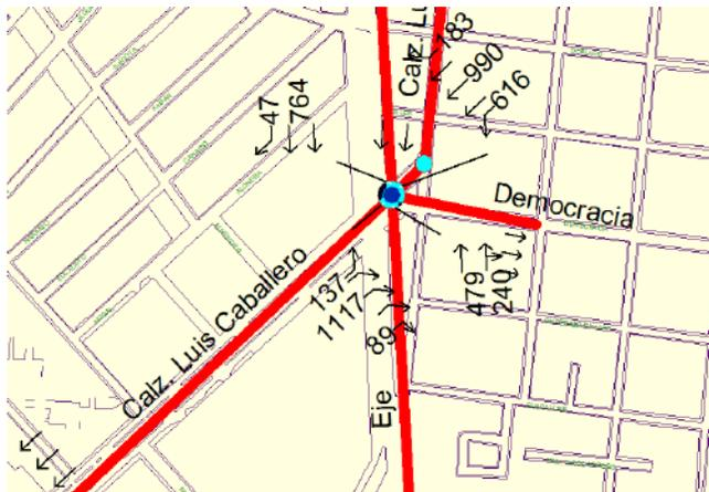
Figura 37. Volumen y movimientos con adecuación intersección 11.
